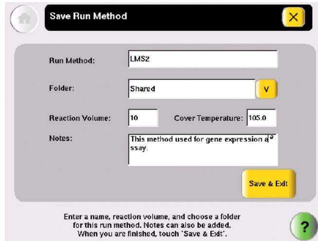
点击“Run Method”，输入 PCR 程序名称；点击
