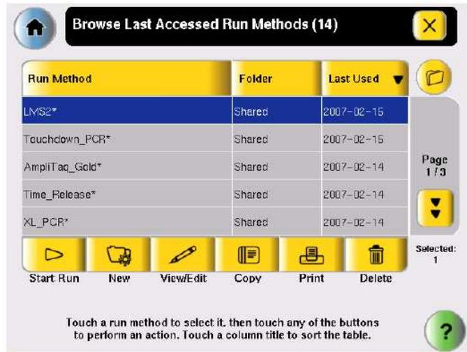
2. 可以直接点击一个 PCR 程序，选择“Start Run”运行；点击右边的
