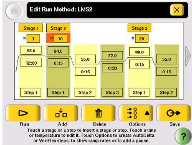
4. 修改循环数、温度、时间：点中循环次数、温度或时间位置，下方出现数字键。依次点数字键，出现合适数字后，点击“Done”确定。
