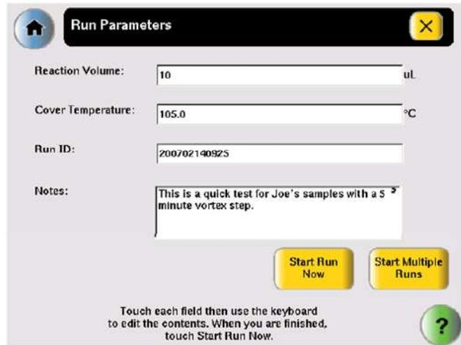
输入反应体积和热盖温度，点击“Start Run Now”开始运行 PCR 程序。
