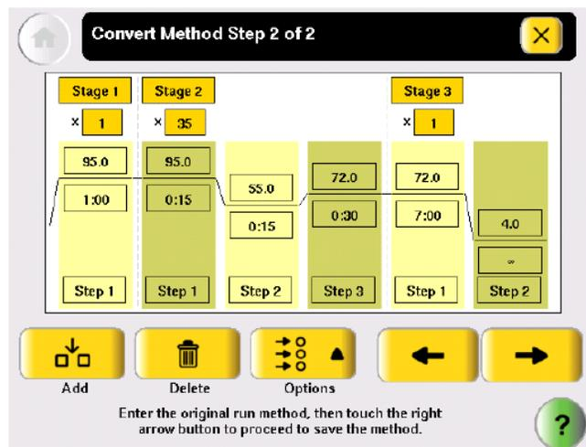
输入 9700 上的 PCR 反应条件，设定 PCR 程序，点击
